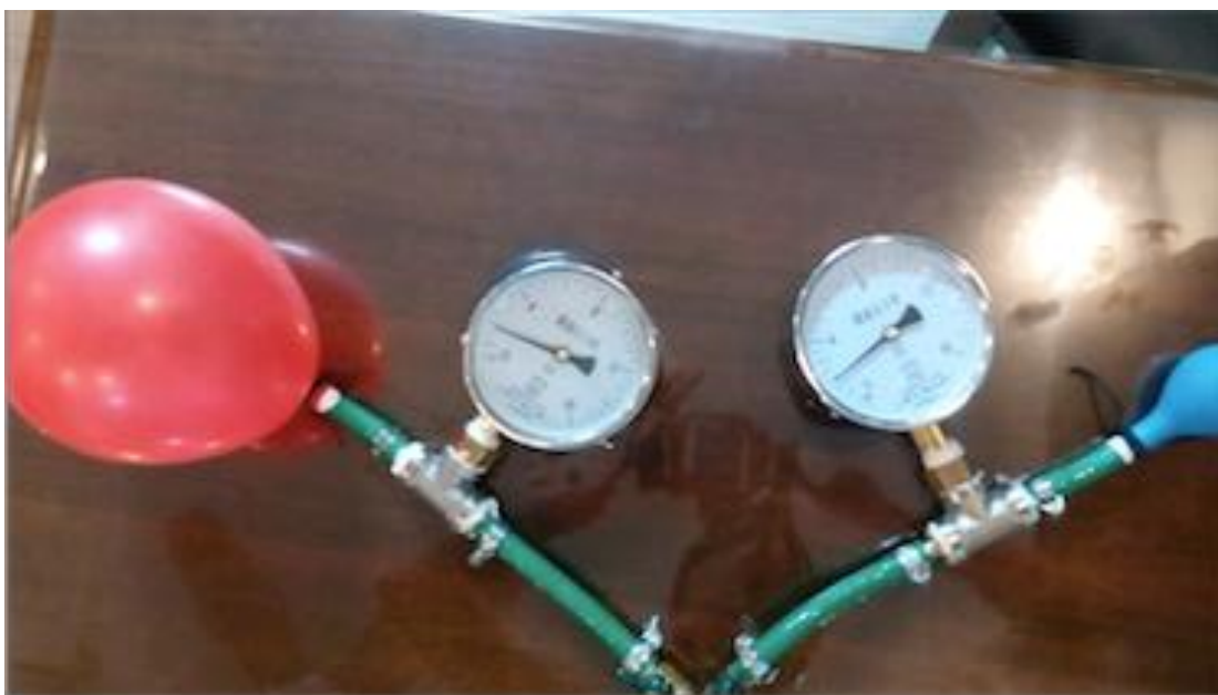
图 2. 小气球缩小至接近初始体积（未充气体积），大气球膨胀，两者体积差距增大
